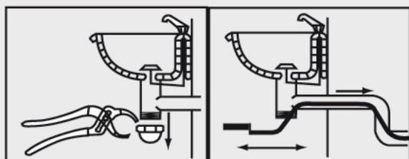
Déboucheur manuel à poignée, équipé d'un flexible acier de 20 mm. Le débouchage se fait en tournant la poignée vers la droite ou vers la gauche suivant la résistance du bouchon. Longueur 3.00 m et fil 8 mm
