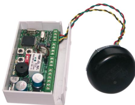
Centrale de contrôle d'accès avec gestion par logiciel RESIDOR OU RESIPRO sur Internet.
