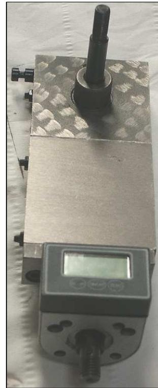
10. Installer le chariot supérieur (417 fig.4) avec le lardon (418 fig.4) sur le support chariot (404 fig.4).
