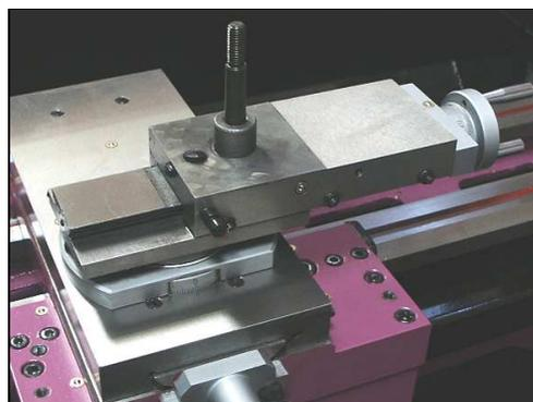
4. Sous le support chariot (404 fig.4), desserrer les 2 boulons M8x20 (403 fig.4) avec une clé de 14.
