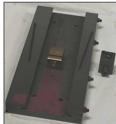
7. Installer le chariot (516 fig.5) avec le lardon (515 fig.5) sur le chariot transversal (509 fig.5).
