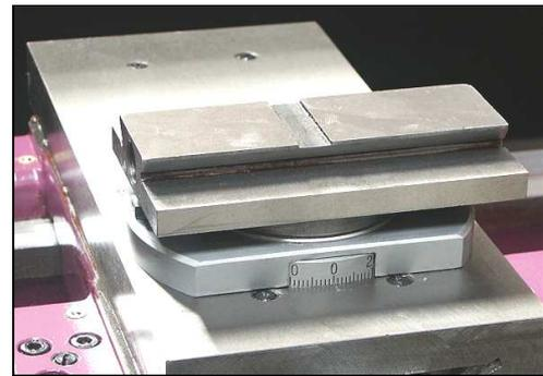
4. Démontez l'ensemble de l'ancienne vis sans fin du supérieur en dévissant les 2 vis M5x16 (424 fig.4).
