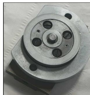
3. Mettre l'ensemble sur le chariot (516 fig.5), le pivoter et le visser avec les 2 boulons M8x20 (403 fig.4).
