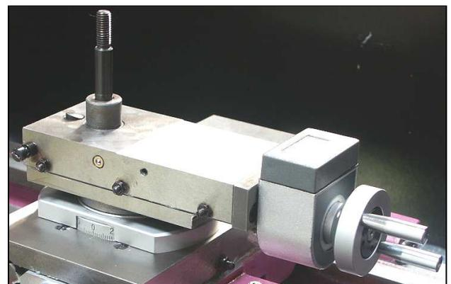
16. Mettre le bouchon dans le trou du support chariot (404 fig.4).
