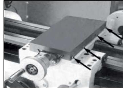
4. Si le mouvement est trop détendu, visser tous les dispositifs de réglage d'un huitième de tour et essayer de nouveau. De façon similaire, si le mouvement est trop rigide, dévisser les dispositifs de réglage d'un tour jusqu'à ce que le réglage soit correct.
