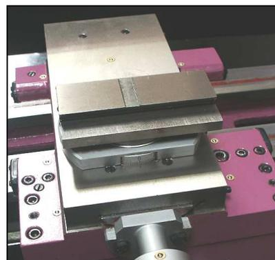
5. Pivoter le support chariot (404 fig.4) et retirer les 2 boulons M8x20 (403 fig.4).
