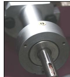
9. Mettre une pile dans un écran digital et le monter sur le palier de vis sans fin avec 3 vis BTR M3x25.
