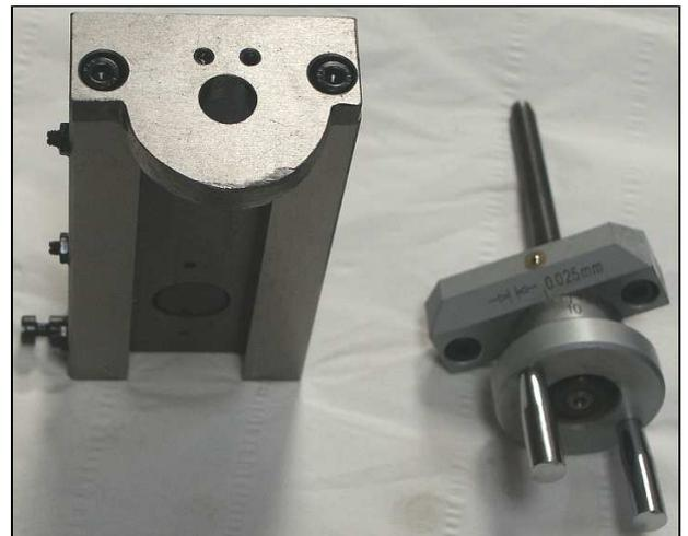
6. Mettre l'entretoise écran digital sur le palier de vis sans fin avec les 2 vis BTR M4x12.
