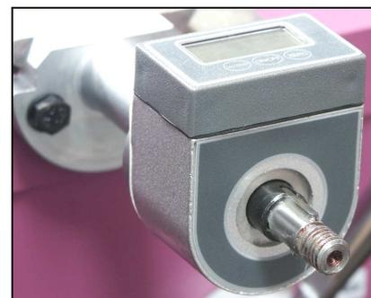
12. Mettre le nouveau volant et le nouvel écrou rond de serrage volant sur la vis sans fin du transversal contre l'écran digital.
