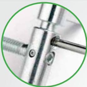
A l'aide de la clé "T" on peut régler la hauteur du pivot, en soulevant ensuite la partie femelle. Le poids du volet est distribué uniformément sur toutes les fiches du châssis grâce à la grande sensibilité du dispositif de réglage en hauteur.
