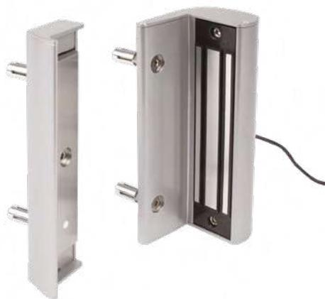
Ventouse électromagnétique à visser sans poignées. Disponible en 2 versions. La MAGMAG3000 avec 300 kg de force de rétention et la MAGMAG5000 avec 500 kg de force. Le coffre en aluminium thermolaqué, prévu avec des fixations uniques Quick-Fix, permet une fixation simple et rapide. Plus de perte de temps avec les soudures et les découpes; uniquement 5 trous pour fixer la ventouse. Le revêtement protecteur à deux couches garantit une utilisation en extérieur sans entretien pour des années.
