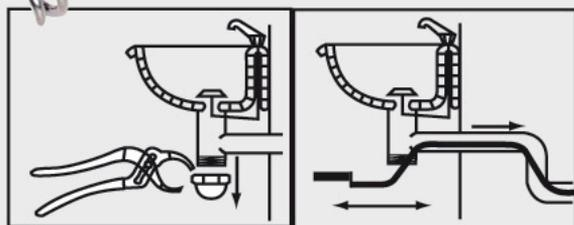
Déboucheur manuel à poignée, équipé d'un flexible acier de 20 mm. Le débouchage se fait en tournant la poignée vers la droite ou vers la gauche suivant la résistance du bouchon. Longueur 7.00 m et fil 8 mm
