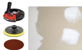
Ponçage du plâtre avec aspiration Plaster sanding with suction
