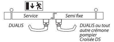
Les deux vantaux sont déclarés issues de secours sous réserve que la manoeuvre de la fermeture d'urgence entraîne l'ouverture du vantail de service et du vantail semi-fixe.
