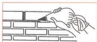
Une dose d'adjuvant convient pour 50 kg de ciment, 20 litres d'eau, ce qui permet la confection d'environ 25 m<sup>2</sup> de joint de brique.
