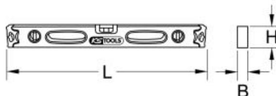
**NIVEAU ALUMINIUM À DOUBLE SEMELLE, L.1000 MM**
