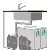
Siphon déporté vers le mur
