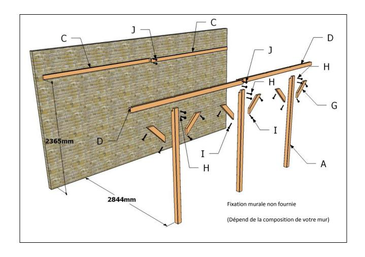
Procédez maintenant à la pose des longerons sur le mur (pièces C). Le système de fixation n'est pas compris parce qu'il est différent en fonction de mur.
