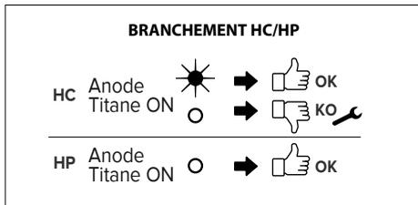
En cas d'installation dotée d'une alimentation électrique pendant la nuit uniquement, afin de garantir a protection de la cuve, AU MOINS UNE FOIS PAR AN, vérifiez régulièrement le fonctionnement du voyant de protection, ce qui force la connexion électrique à passer en mode manuel ON.
