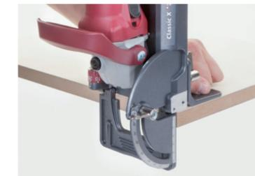
Stabilité verticale assurée par la butée mise sur la plaque de base comme agrandissement de la surface d'appui
