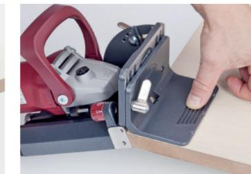
Parfaite précision des onglets grâce à la butée de la surface extérieure pour des angles de 22.5 et 45°
