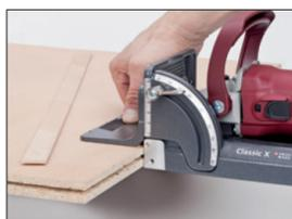
Fraiser des rainures en continu pour joint embrevé et assemblage à fausse languette
