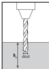
Percer au diamètre **dcut** et à la profondeur **h<sub>1</sub>** et nettoyer le trou foré.
