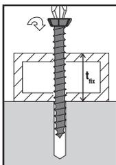
Insérer la vis **BETASPEED** à travers la pièce à fixer dans le trou foré.
