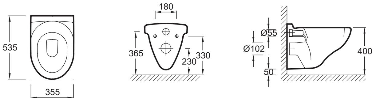
Descriptif CCTP : Cuvette suspendue, sans trou d'abattant. E1755. Collection : COLLECTIVITÉ. DIMENSIONS : 53,50 x 35,50 cm. POIDS : 15 kg. MATÉRIAU : Céramique. TYPE D'INSTALLATION : Suspendu. CONSOMMATION D'EAU : Economie d'eau 2,6/4 L. HAUTEUR : Réglable de 38 à 50 cm. BRIDE : 1.
