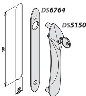
Usinage pour la poignée extérieure DS5150 avec platine DS6764.
