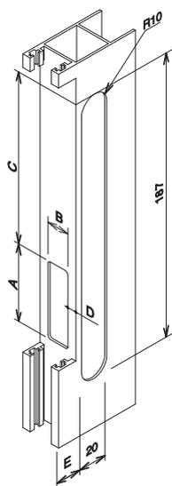
Usinage des cuvettes intérieures et extérieures
