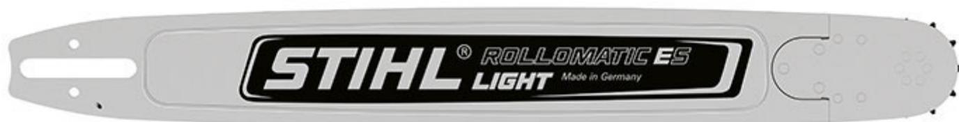
En acier spécial résistant à l'usure. Les interstices sont fraisés et soudés selon un procédé laser spécial. Corps creux très stable et une structure supérieure et inférieure résistante à la flexion, réduction du poids de 30 % par rapport au Rollomatic ES, orifices de lubrification obliques STIHL Ematic S, tête du guide-chaîne complètement interchangeable. Aucun entretien nécessaire grâce aux roulements fermés du pignon de renvoi.
