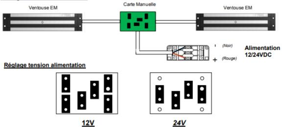
Positionner les jumpers de la carte en fonction de la tension d'alimentation souhaitée
