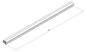
4- Finaliser l'assemblage du profil poignée à l'aide des 7 Vis 3.5 x13 fournies
