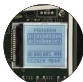
AUTO-PROGRAMMATION AU MOYEN D'UN AFFICHEUR LCD GRAPHIQUE CC242ETOPCB - CC242EXTOPCB
