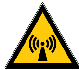
Danger radiations non ionisantes
