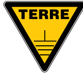
Danger, prise de terre
