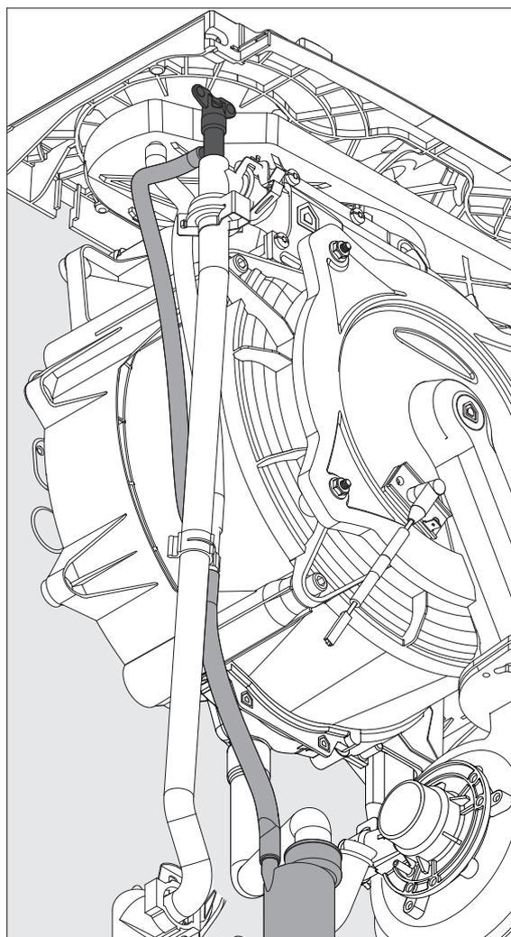
**Avant la première mise en route de l'appareil, il est impératif de remplir le siphon de la chaudière avec de l'eau. Le siphon est rempli d'eau pendant l'opération de purge de l'air de l'échangeur principal - voir p. 22**
