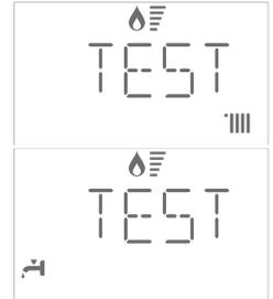
La chaudière est activée à la puissance maximale.
