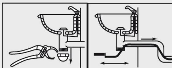
Déboucheur manuel à poignée, équipé d'un flexible acier de 6 mm. Le débouchage se fait en tournant la poignée vers la droite ou vers la gauche suivant la résistance du bouchon. Longueur 3.00 m et fil 6 mm
