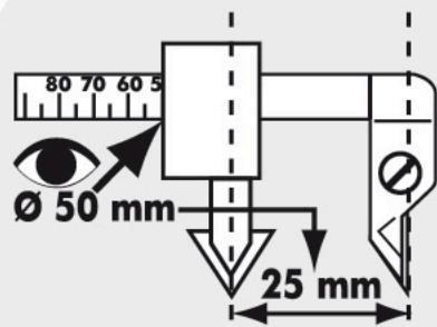
A utiliser avec une perceuse portative. La forme de la lame et l'encoche de protection évitent toute altération de celle-ci. Mèche et lame en acier forgé et carbure de tungstène. Bras de déport gradué Capacité de 23 à 93 mm.
