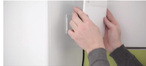
19. Positionnez la passerelle sur son support
