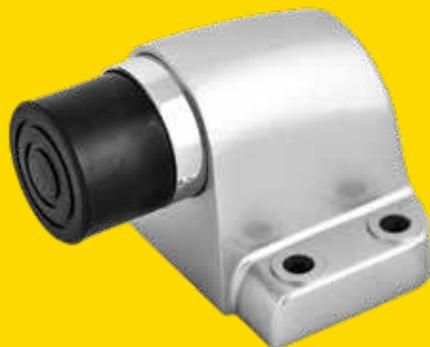
Dotés de **4 points de fixations**, les arrêts de portes lourdes sont testés à **100.000 ouvertures de portes lourdes** (120 kg) et **240h de brouillard salin**. Ils existent également en butoir de porte lourde aimanté avec une force de retenue de 35 kg.
