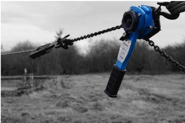
Le palan à levier Bravo est un appareil de levage manuel utilisé pour soulever, tirer ou positionner des charges lourdes suspendues à une chaîne de levage au moyen de la force humaine appliquée sur le levier de manœuvre. Le palan Bravo Efficient peut être amarré à un point d'accrochage fixe (ex : pince Corso\*) ou à un chariot mobile (ex : chariot Corso\*).
