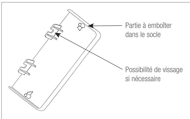
En raison de la forme asymétrique de la dimension 165 x 60 il existe pour cette goulotte un embout droit et un embout gauche.
