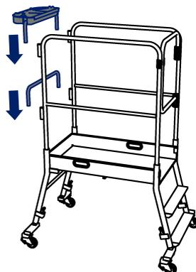
**5** Assembler la tablette et la lisse sur les garde-corps. Ces 2 éléments peuvent être inversés selon le besoin.
