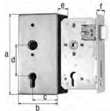
Instruction de montage: Pour modifier le sens d'ouverture (DIN gauche/DIN droite) passer un tournevis dans la rainure de la tête du pêne. Pousser alors le pêne vers l'avant et le faire pivoter de 180°.
