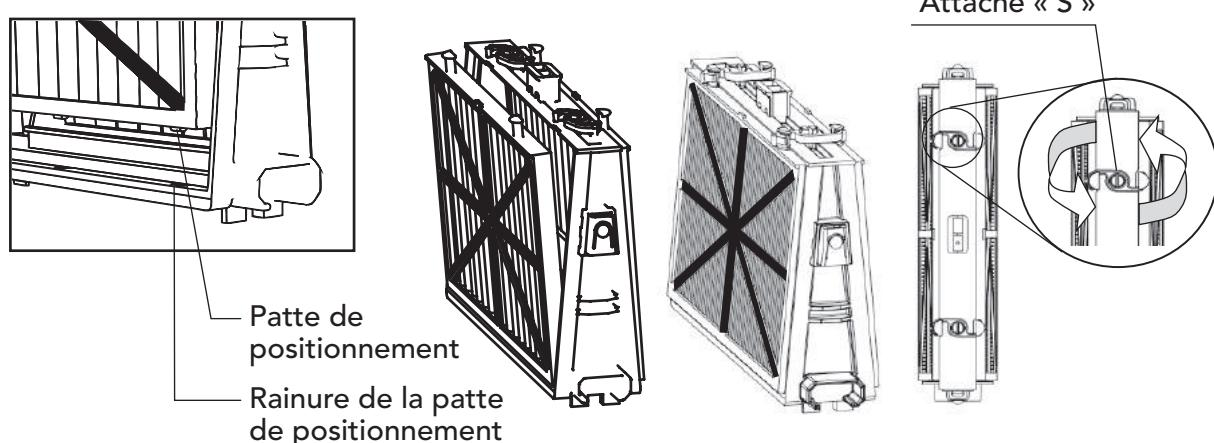
Réinstallez les châssis de base avec des filtres selon le schéma.
