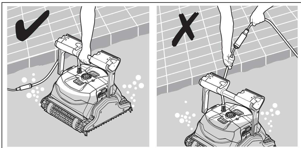
**!** NE PAS RETIRER LE NETTOYEUR DE LA PISCINE EN TIRANT SUR LE CABLE.
