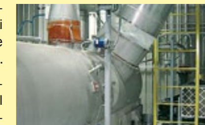
Impianto con tecnologia a letto fluido per l'ottenimento delle formulazioni in microgranuli idrodispersibili e l'impianto di confezionamento A-Z Drying (Osage, IA).
