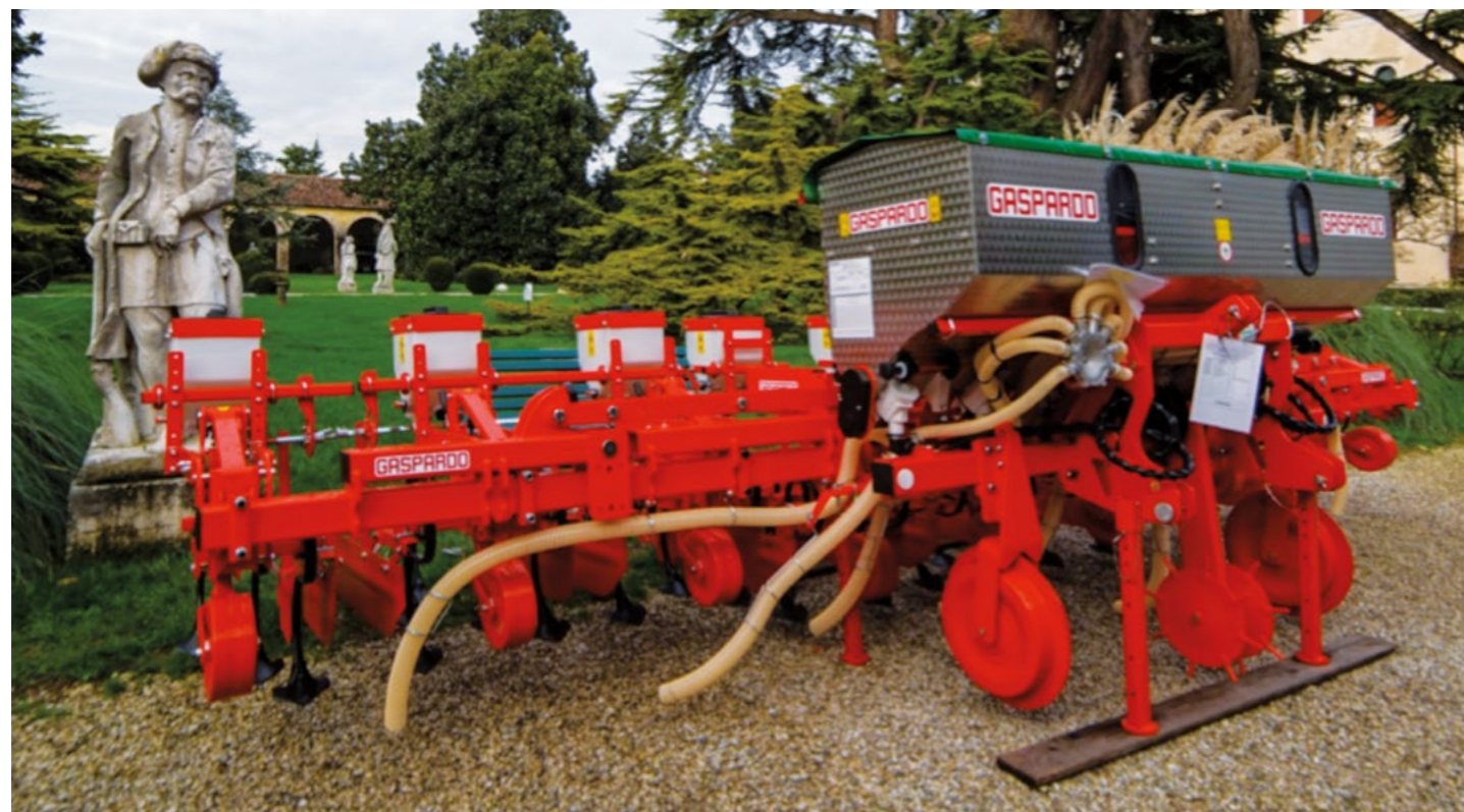
Sarchiatrice Gaspardo mod. HS a 8 file dotata di sistema Micromax specifico per applicazione di ERCOLE: nel riquadro in basso è visibile il sistema distributore e gli assolcatori per interrimento di ERCOLE (presentazione al Castello di Roncade - TV).
