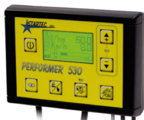
Centralina Performer 530 di Startec Srl che equipaggia la sarchiatrice. Questa adatta in continuo la dose distribuita in funzione della velocità di avanzamento, permettendo di monitorare dose distribuita e superficie lavorata
