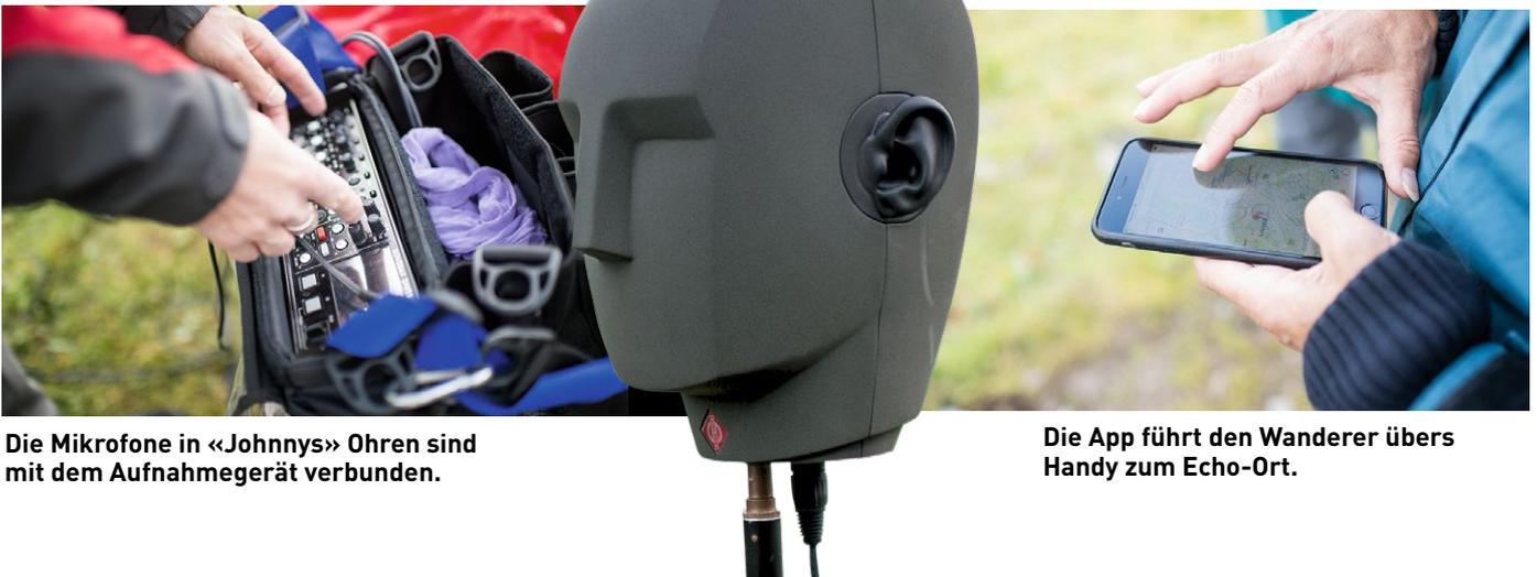
Die Mikrofone in «Johnnys» Ohren sind mit dem Aufnahmegerät verbunden.
