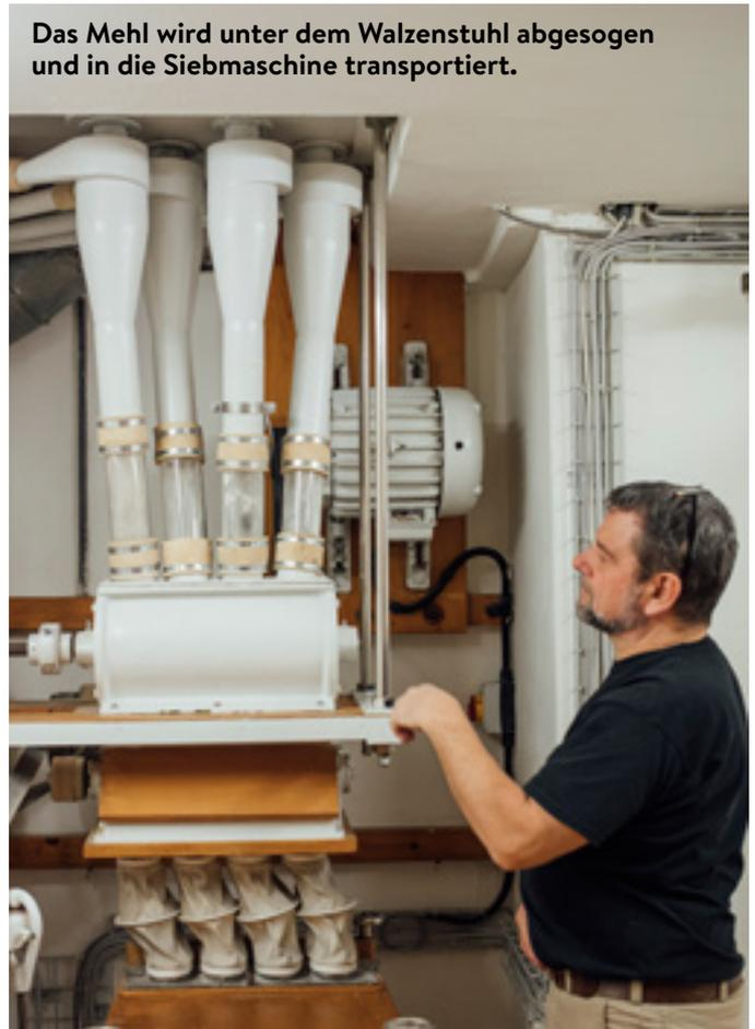
Das Mehl wird unter dem Walzenstuhl abgesogen und in die Siebmaschine transportiert.
