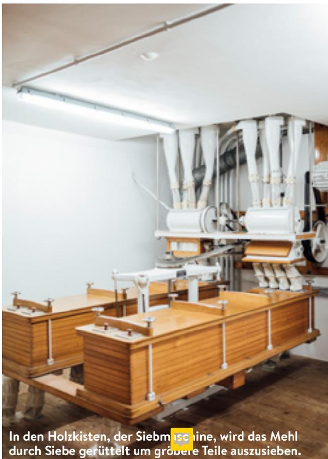
In den Holzkisten, der Siebmaschine, wird das Mehl durch Siebe gerüttelt um größere Teile auszusieben.
