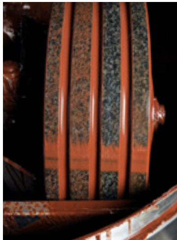
Ein Steinrad mahlt die Kakao-masse während 90 Stunden.
