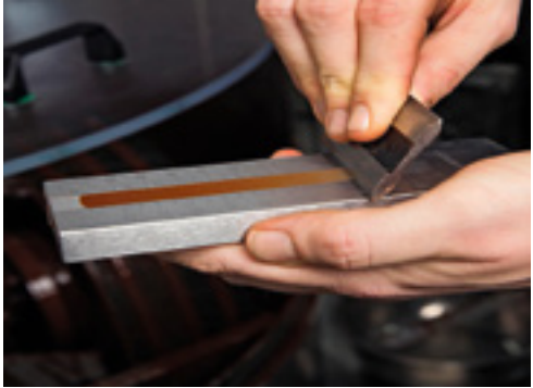
Mit dem Grindometer bestimmt Kay Keusen die Feinheit der Schokolade.
