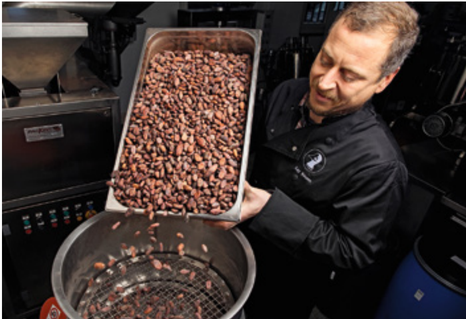
Um Holz oder kleine Steine auszusortieren, leert Kay Keusen die Bohnen in ein rotierendes Sieb.
