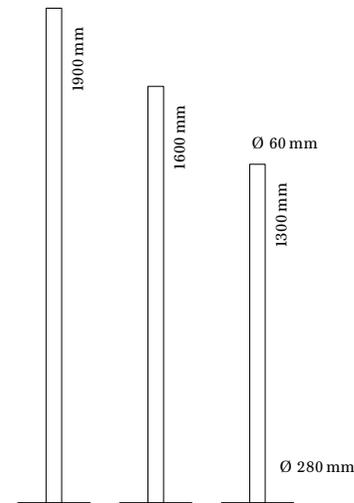
Material: Acrylglas, Stahl pulverbeschichtet
