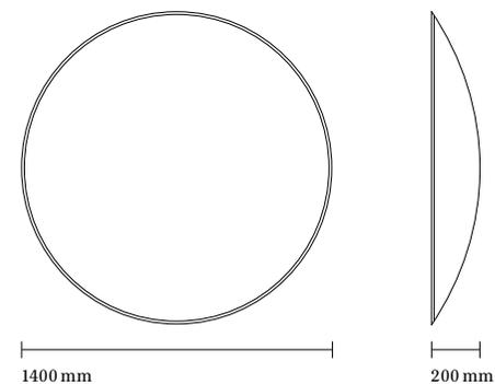
Material: Membrane aus Faserglas, Stahlrahmen
