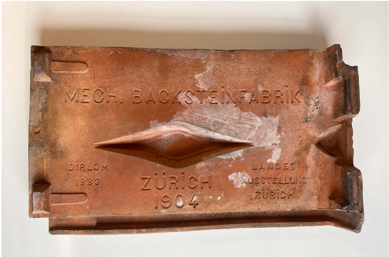
Abb. 8: Rückseite Dachziegel von 1904 (Foto: Curschellas & Gasser Architekten)
