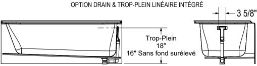
Le modèle du support de bois peut varier. Bride de carrelage simple intégrée: 1" hauteur X1/4" épaisseur ( illustrée) Bride de carrelage double intégrée: 2 3/8" hauteur (non illustrée)
