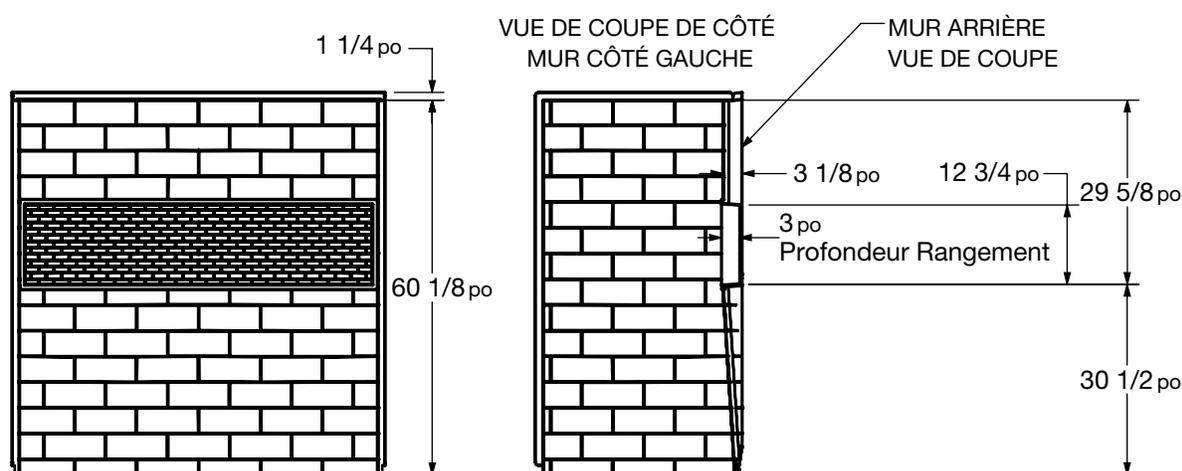
Toutes ces dimensions sont approximatives. Afin d'assurer une installation parfaite, les dimensions de la structure doivent être vérifiées à partir de l'unité.
