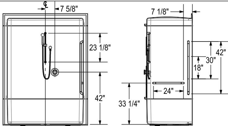
Toutes les dimensions sont approximative. Les mesures de la structure doivent être vérifiées par rapport à l'unité pour assurer un ajustement approprié
