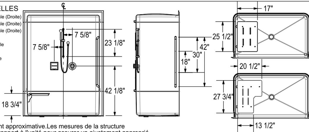
Toutes les dimensions sont approximative. Les mesures de la structure doivent être vérifiées par rapport à l'unité pour assurer un ajustement approprié
