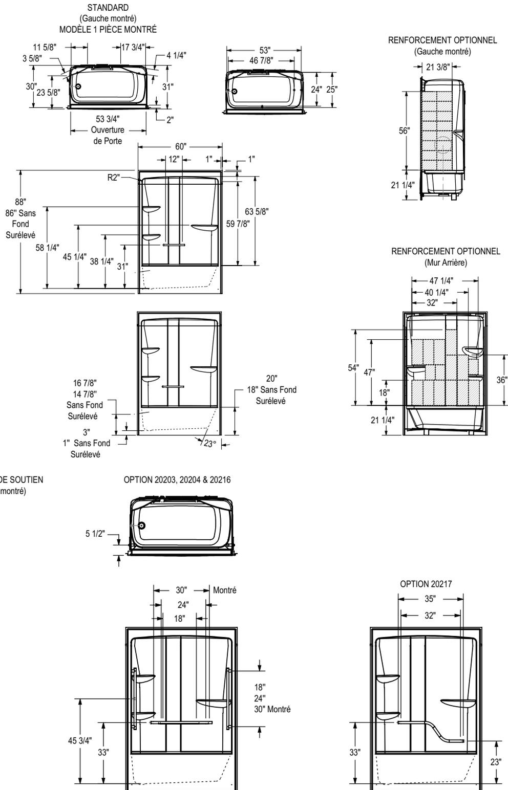
Toutes ces dimensions sont approximatives. Afin d'assurer une installation parfaite, les dimensions de la structure doivent être vérifiées à partir de l'unité.
