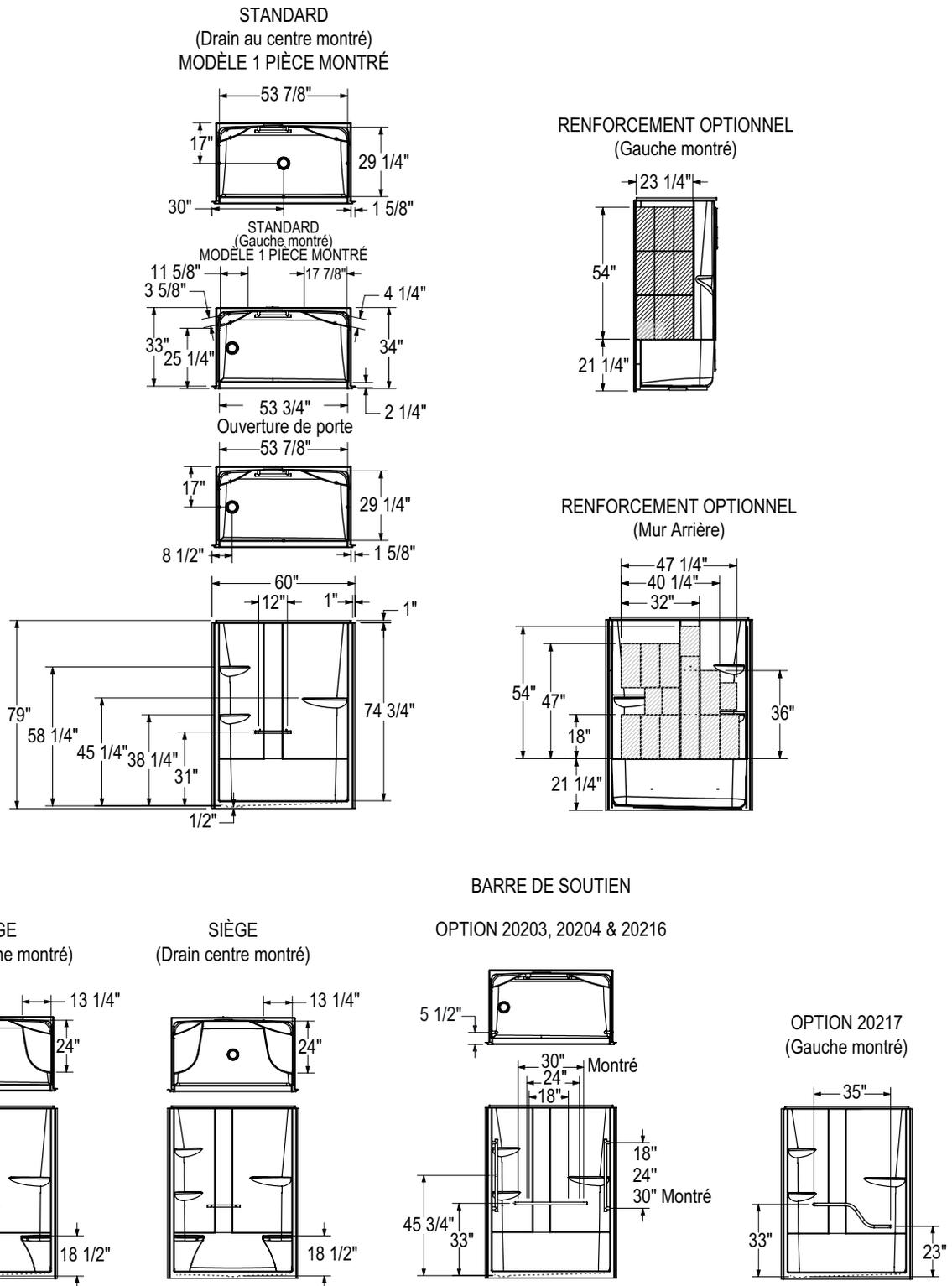
Toutes ces dimensions sont approximatives. Afin d'assurer une installation parfaite, les dimensions de la structure doivent être vérifiées à partir de l'unité.
