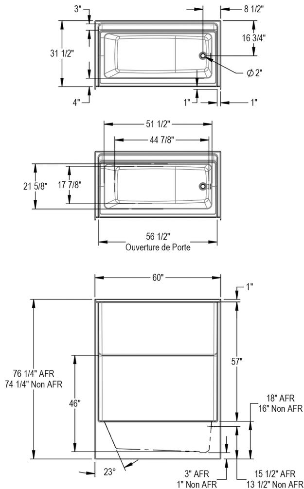
Toutes ces dimensions sont approximatives. Afin d'assurer une installation parfaite, les dimensions de la structure doivent être vérifiées à partir de l'unité.
