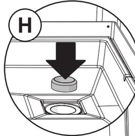
**I.** Aplica peso o baja presión en el área del desagüe para asegurarte de que caigas al desagüe. Atornilla el anillo de compresión hasta que quede bien ajustado, lo que sellará y mantendrá firme la inclinación del suelo hacia el desagüe.
