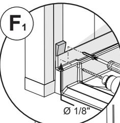
**F.** Si es necesario, utilice cuñas de madera entre los montantes y la brida de fijación para mantener la posición centrada de la bandeja y evitar la distorsión de la brida.
