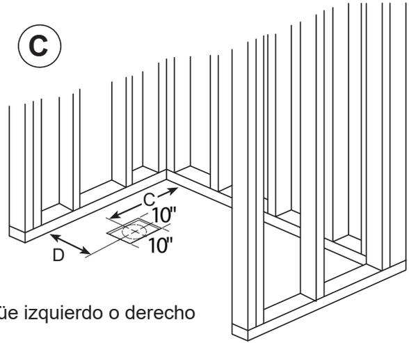
C. Recorta una abertura adecuada de 10 x 10 pulgadas alrededor del centro del desagüe delineado con las medidas C y D. Consulta las imágenes de la derecha y la tabla del paso 1.a (en la página 4). Recomendamos que un plomero complete la conexión del tubo de desagüe.
