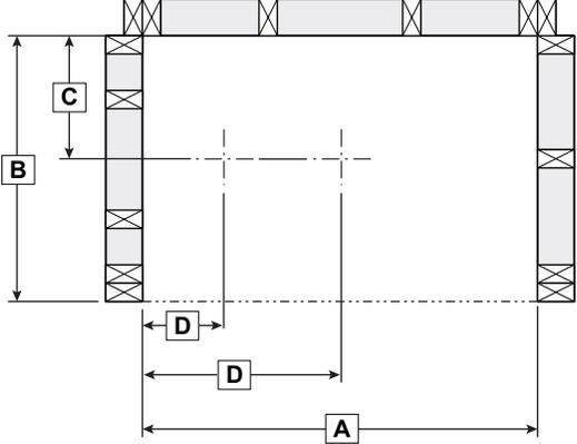
A. Planifique el diseño de los montantes para dejar espacio para la válvula de control y las salidas de agua.
