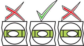
**!** La nivelación del suelo es fundamental para una instalación correctamente alineada. Para nivelar el suelo se puede utilizar un mortero de fraguado rápido y automático. Tenga cuidado de no bloquear la posición del orificio de drenaje.
