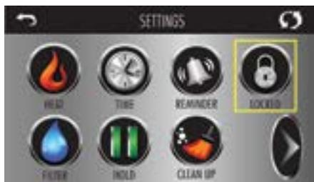
La commande peut être limitée afin d'empêcher une utilisation ou des réglages de températures non souhaités. Le verrouillage du panneau empêche l'utilisation du contrôleur, mais toutes les fonctions automatiques sont toujours activées.
