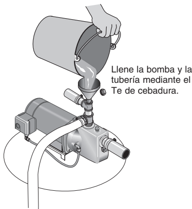
Figura 9: Cebadura de la bomba
