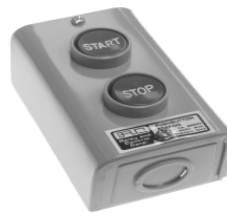
start-stop, 600 volt / 10 amps momentary contacts Nema 1 metal enclosure, CSA
