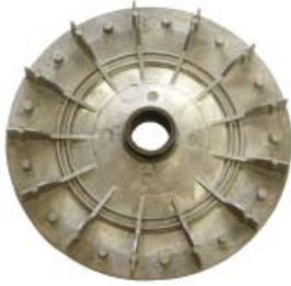
internal cooling fan
