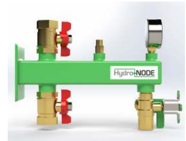
Support mural avec 2 robinets à bille, purgeur d'air manuel 1/4", manomètre et robinet 3 voies ETV-1
