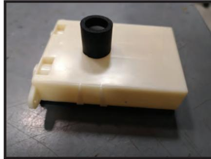
3. Un raccord ou un adaptateur de 1/2" s'ajustera parfaitement sur le tuyau de caoutchouc de 1/2". Un raccord ou un adaptateur de 3/4" s'ajustera parfaitement sur le tuyau de 5/8". Cette méthode assure l'étanchéité de l'ensemble tout en permettant d'enlever facilement le purgeur de condensat aux fins d'entretien.
