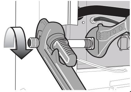
Installez une soupape d'arrêt manuelle du gaz et un collecteur d'impuretés le plus près possible de la fournaise. Certains codes locaux exigent que la soupape d'arrêt manuelle du gaz soit installée entre 4 et 5 pieds (1,2 m et 1,5 m) au-dessus du sol pour en restreindre l'accès aux enfants. Assurez-vous que la soupape est facilement accessible.
