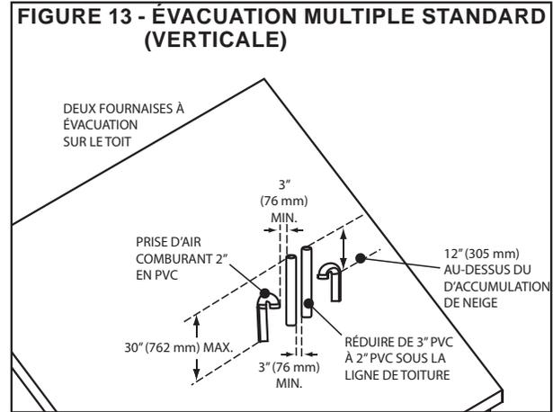
Lorsque plusieurs fournaies sont installées à proximité l'une de l'autre, chacun des ensembles de prise d'air comburant et de terminaison d'évacuation supplémentaires doit se trouver à au moins 12" (305 mm) l'un de l'autre.
