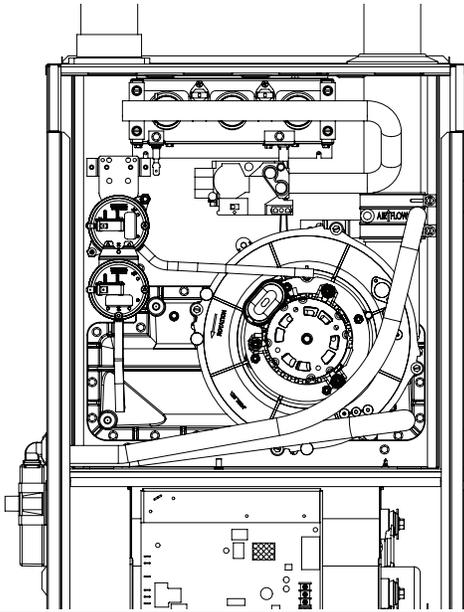
ÉVACUATION AU DESSUS - INSTALLATION DU DRAIN À DROITE
