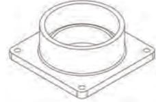
Le raccord de la prise d'air comburant consiste en une douille de 2" en PVC fixée à un adaptateur de bride. Installez l'adaptateur sur l'extérieur du panneau extérieur à l'aide des vis fournies (assurez-vous que le joint est placé correctement entre l'adaptateur et l'extérieur du panneau extérieur pour le propre scellant). **La garantie sera annulée si vous omettez d'installer le joint d'étanchéité sur l'extérieur du cabinet.**
