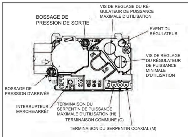
FIGURE 26 - ENSEMBLE DE VÉRIFICATION DE LA PRESSION DE LA SOUPAPE
