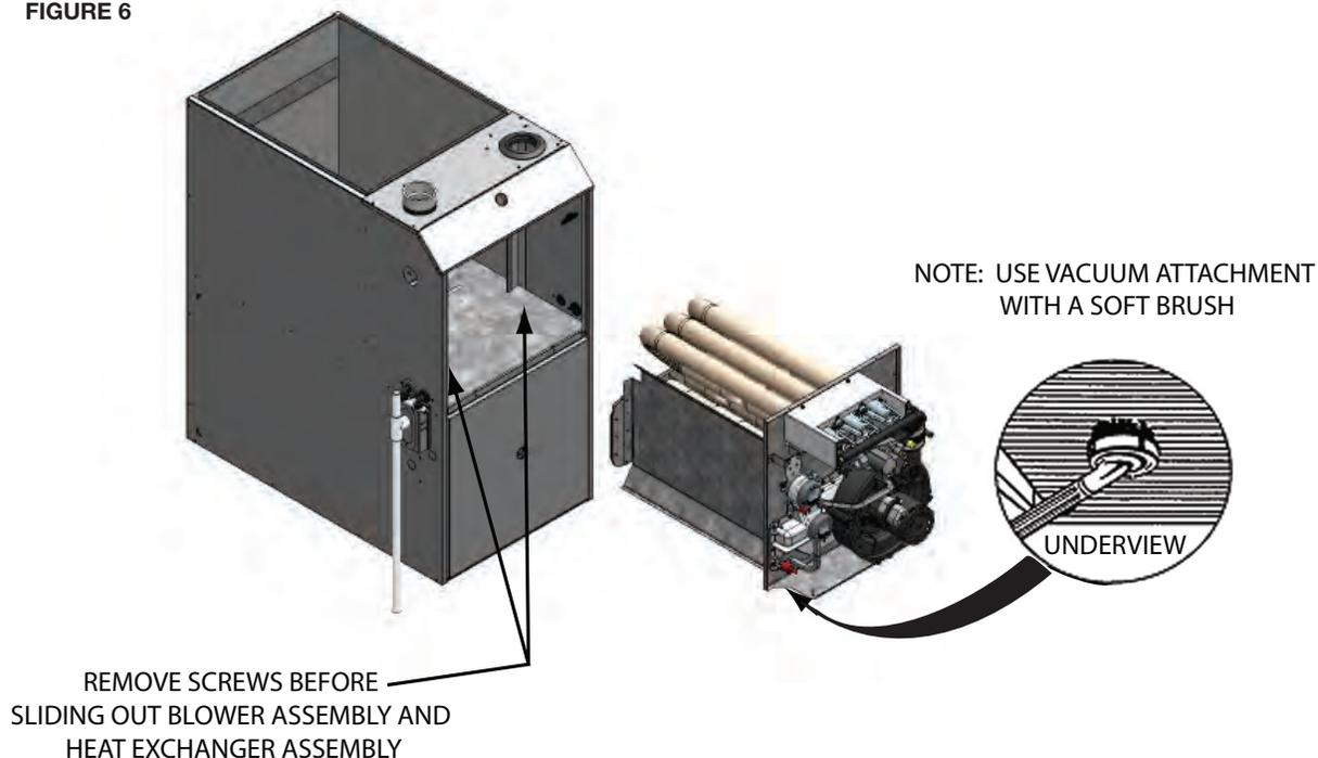
9. Lorsque du nettoyage, glissez l'échangeur de chaleur dans sa position d'origine en utilisant les trous de vis du panneau de division pour l'alignement.
