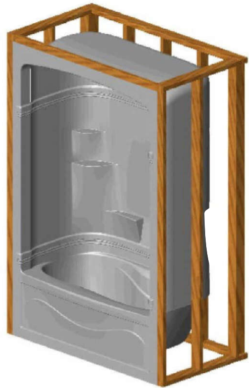
ILLUSTRATION 4 - POUSSER L'UNITÉ DOUCHE/BAIGNOIRE CONTRE LES MURS DE LA CHARPENTE
