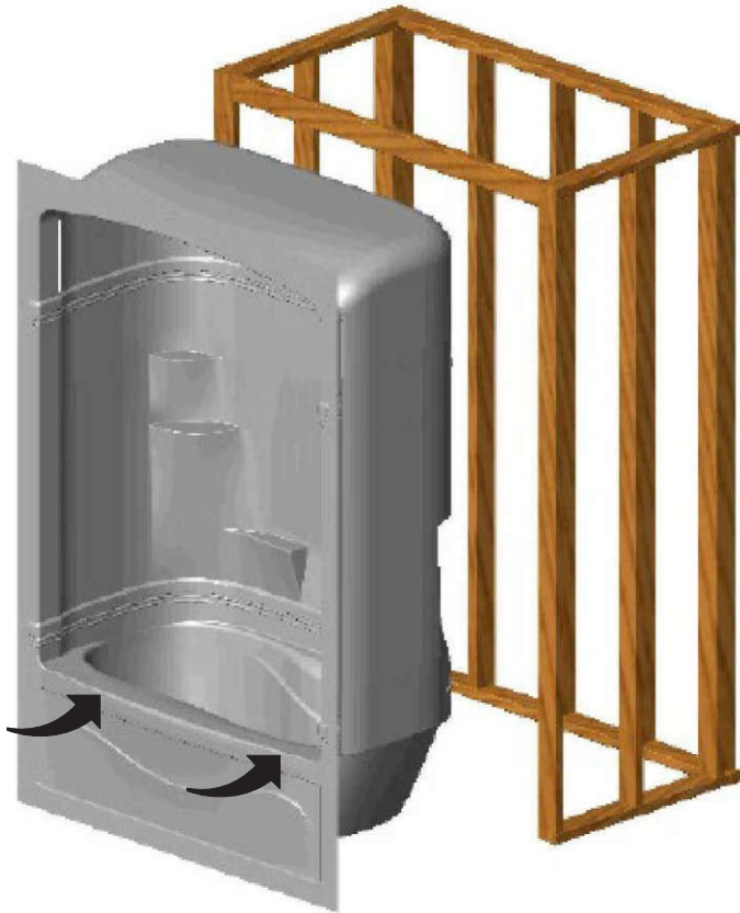
ILLUSTRATION 3 - POSITIONNER L'UNITÉ DEVANT L'ENCADREMENT
